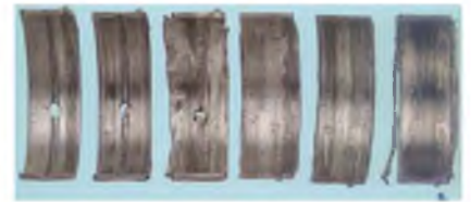
Fot. 8 Wynik zbyt ubożego smarowania lub braku oleju w układzie.
