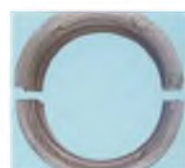
Fot. 7 Uszkodzenie wynikające z nadmiernego nacisku spowodowanego niewłaściwym luzem poosiowym.
